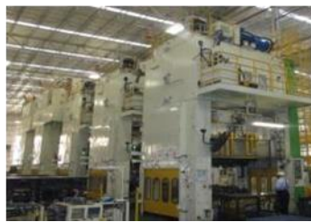
Figura 2.5 Líneas de producción estampado (Izquierda Línea BL800 Ton, centro Línea TD400 Ton, derecha Línea TF1500 Ton).
